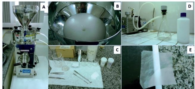
**FIGURA 1** – Etapas da produção das nanofibras de celulose vegetal: A) moinho Mass Colloider Masuko; B) suspensão de celulose sendo processada pelo moinho; C) utensílios típicos usados para produção de suspensão de celulose nanofibrilada; D) filtração a vácuo para produção de filmes; E) membrana produzida
