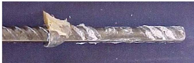
Figura 10 - Comportamento da ancoragem a 0° (a), 45° (b) e 90° (c) em relação às fibras da madeira de Pinus oocarpa, utilizando adesivo epóxi Compound Injeção em diferentes corpos de prova
