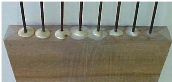
Figura 6 - Formas de ruptura de ancoragens na madeira
