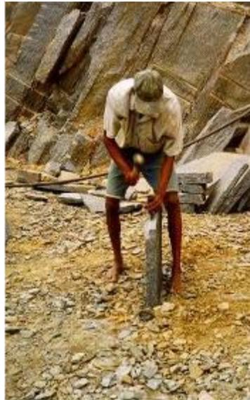
As placas de pedra, então, são transportadas de caminhão para as empresas de beneficiamento, onde são cortadas por pequenas serras circulares de corte, providas de disco diamantado, nas dimensões finais das rochas ornamentais (Figura 4). Por fim, essas pequenas placas são novamente “fatiadas” manualmente (Figura 5), obtendo-se, finalmente, o produto final, as placas de rochas ornamentais.
