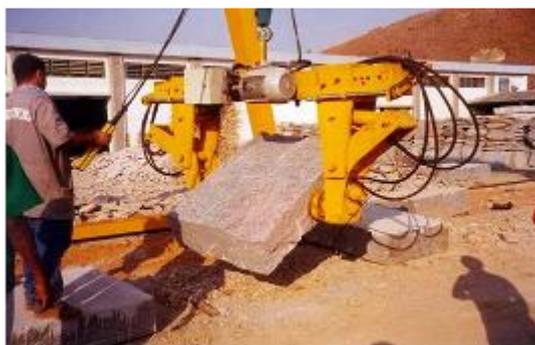
Para projetar esse pórtico rolante, de forma a atender aos requisitos técnicos da descarga e corte de blocos de pedras decorativas, foi necessário desenvolver uma inovação tecnológica, a “*pinça hidráulica*”, um mecanismo que possibilitasse a descarga do bloco de pedra de grandes dimensões.
