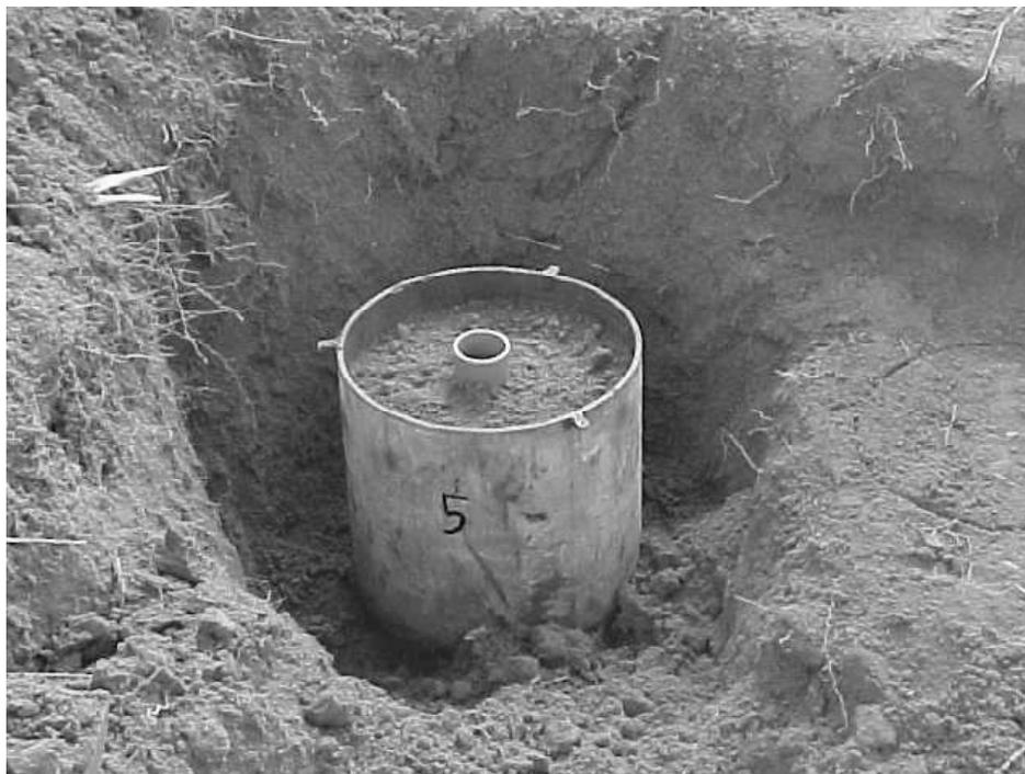
**FIGURA 5** – Exemplo de monólito para calibração de sonda de capacitância.
