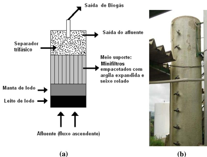
Figura 1 – Reator anaeróbico híbrido (RAH) localizado no NECAF/UFLA. (a) Desenho esquemático do funcionamento do reator anaeróbico híbrido (RAH); (b) vista parcial.
