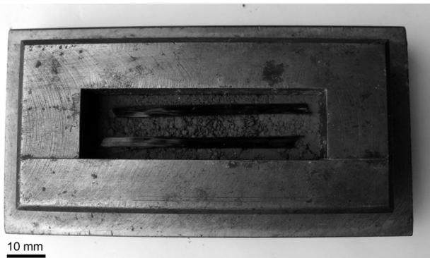
Figura 2: Adição de fibra de carbono unidirecional.
