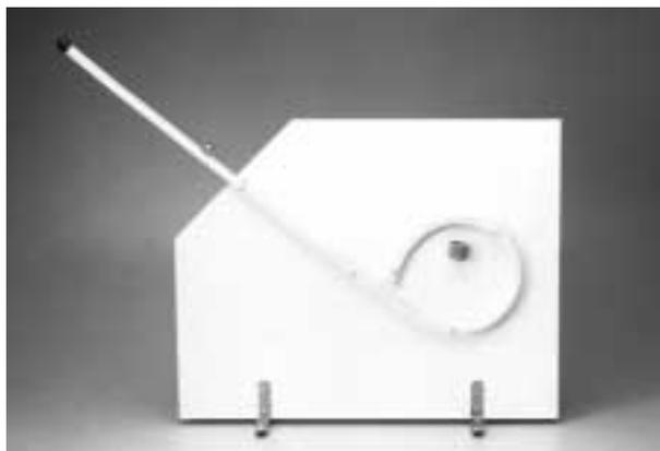
Placa-suporte<sup>5</sup> com um trilho inclinado em uma extremidade e em forma de *looping* na outra, com uma cestinha fixada na área interna ao *looping*, e uma bolinha de metal.<sup>6</sup>
