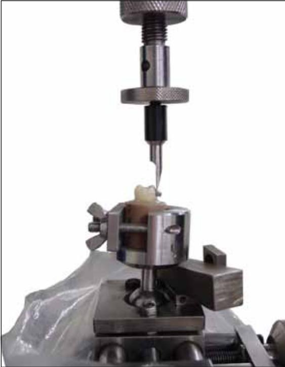
FIGURA 6 - Posicionamento do dispositivo para o teste de cisalhamento.
