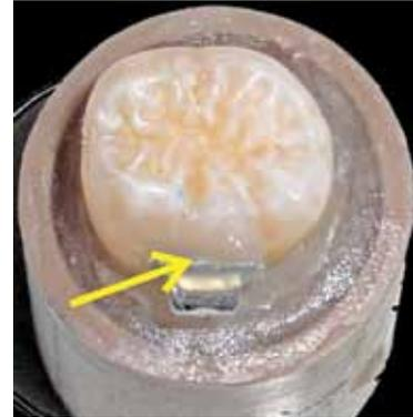
FIGURA 4 - Corpo de prova do Grupo 1: colagem direta convencional seguida pela aplicação de uma camada adicional de resina na oclusal da interface tubo/dente.
