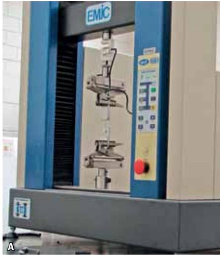
FIGURA 2 - (A) Máquina universal de ensaios EMIC e (B) Dispositivo para teste.
