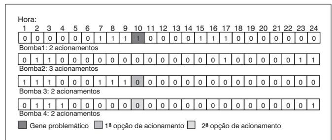
Figura 4 – Aplicação da reparação relativa à potência máxima por bombas
