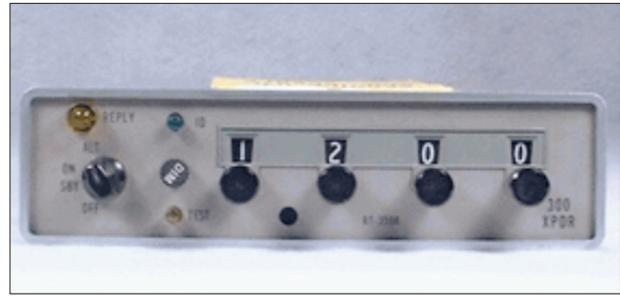
Figura 3: ARC (Cessna) RT-359A *Transponder*. Fonte: Bennet Avionics (2010).
