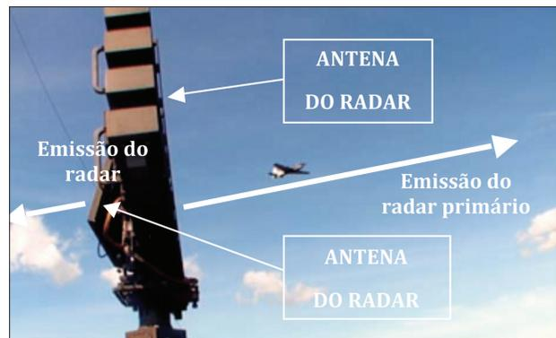
Figura 4: Radar SABER M60 (antenas do radar primário e IFF solidárias, com emissão defasada em  $180^\circ$ ). Fonte: adaptado de Abdalla (2008).
