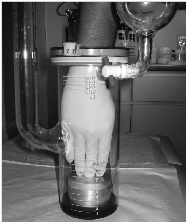
**Figura 4** - Fotografia mostrando o volúmetro com câmaras comunicantes em situação hermética para a coleta de medidas segmentares, encontrando-se vedado pela luva e anéis limitadores de borda e de fixação, bem como o posicionamento da mão a ser adotado durante sua submersão para a leitura volumétrica
