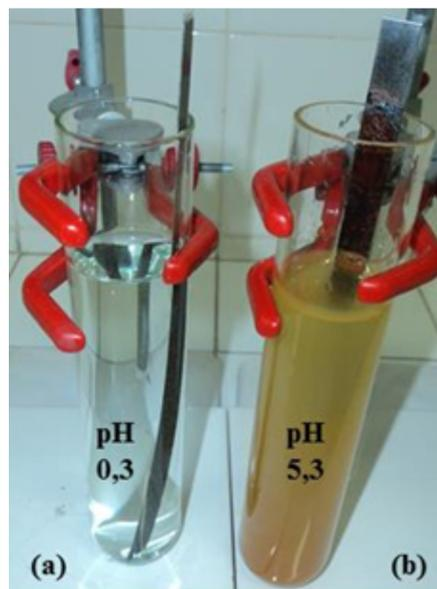
Figura 3. Ensaio de corrosão no início (a) e após uma semana (b)
