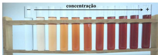
Figura 2. Padrões colorimétricos de soluções de  $\text{Fe}^{3+}_{(\text{aq})}$  na forma de  $[\text{Fe}(\text{SCN})_n]^{3-n}_{(\text{aq})}$
