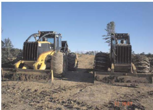
**Figura 1** – Skidder de pneus e skidder de pneus recobertos por esteiras avaliadas no trabalho.
