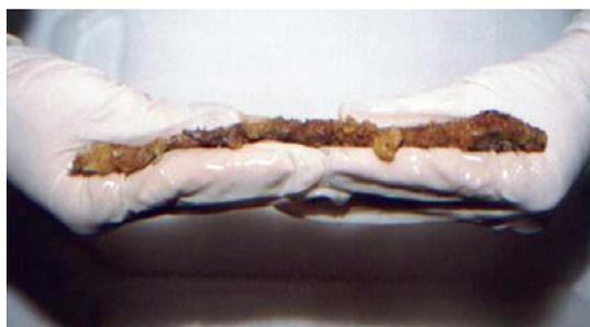
**Figura 5** – Camada lamelar com espessura fina e constante nas peças dissecadas.
