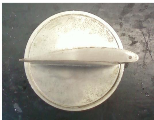
Figura 1 - Perfil aerodinâmico NACA 4412 utilizado no experimento.
