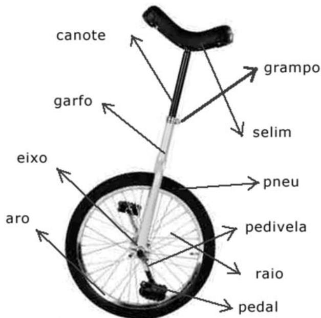
Figura 1 - Componentes de um monociclo.
