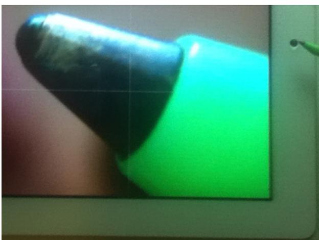
Figura 2 - Fotografia de uma caneta e sua imagem gerada em um *tablet* com a técnica da gota. A caneta e a lente da câmera, coberta pela gota, podem ser vistas no canto superior direito da figura. Repare que para formar uma imagem nítida da caneta, é necessário aproximá-la da gota (cerca de 3 mm), conforme discutido no texto.
