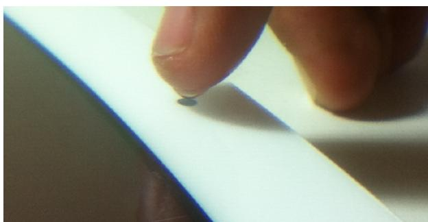
Figura 3 - Fotografia de uma gota sendo acomodada à lâmina protetora da câmera de um *tablet*.
