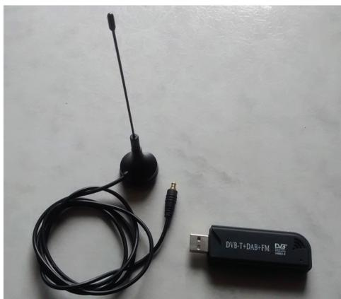
**Figura 4:** Dongle RTL – SDR. Na fotografia vemos também a antena dipolo normalmente fornecida com o dongle. Neste trabalho ela foi substituída pela antena Yagi LFA.
