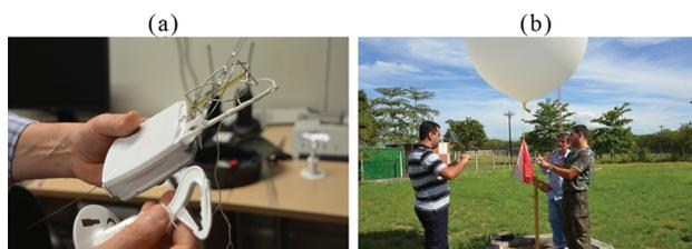
**Figura 1:** Fotos tiradas na EMA Galeão (Aeroporto Internacional Tom Jobin - Rio de Janeiro/RJ) no dia 08/12/2014: (a) detalhe da radiossonda RS92-SGP e (b) lançamento da radiossonda no horário de 12:00 UTC.
