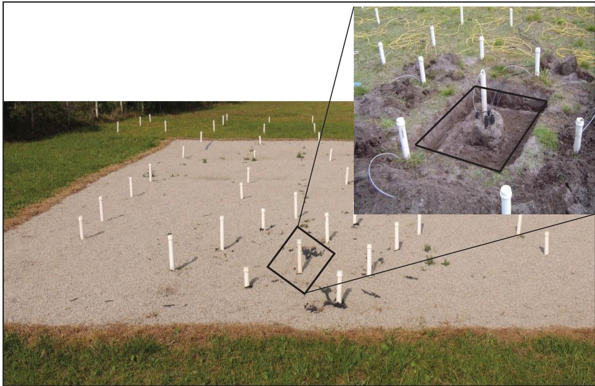
**Figura 3 - Localização da área de liberação do E85 na área experimental. O detalhe demonstra a trincheira escavada no solo no entorno do poço fonte (PF) para liberação do E85 na zona não saturada**
