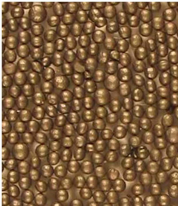
Figura 1 - Microesferas sinterizadas de  $UO_2$ .
