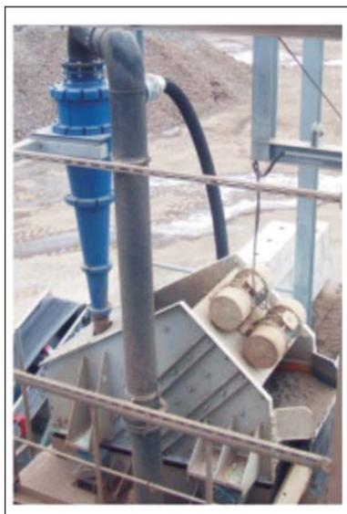
Figura 4 - Ciclone e peneira desaguadora.
