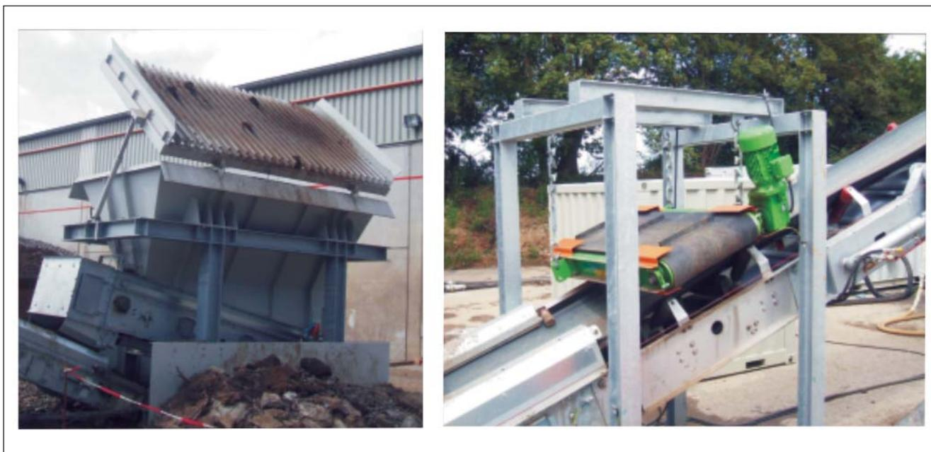
Figura 1 - Tremonha de alimentação (à esquerda) e extrator magnético (à direita).
