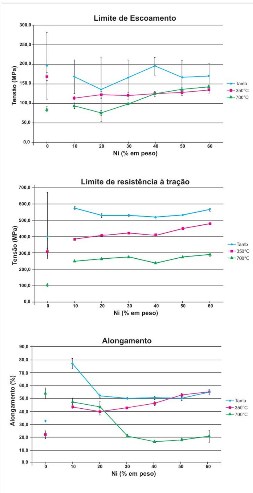
Figura 2 - Efeito da temperatura nas propriedades mecânicas de ligas de níquel.
