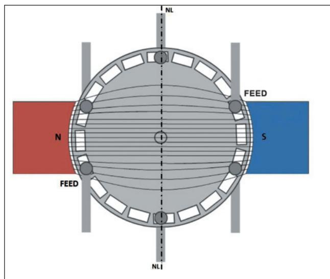
**Figura 3 - Linha neutra bipolar (2 pontos de alimentação/rotor).**
