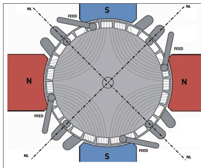
**Figura 4 - Linha neutra tetrapolar (4 pontos de alimentação/rotor).**
