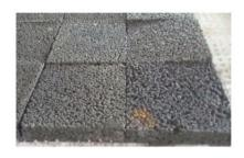
(d) Final concrete slabs (25 cm×25 cm×6 cm) after cut.
