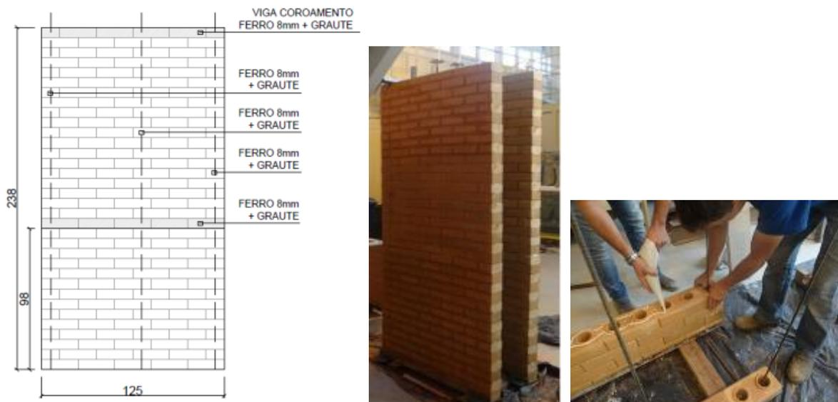
**Figura 2:** Esquema da construção do corpo-de-prova e imagem dos corpos de prova usados no ensaio.
