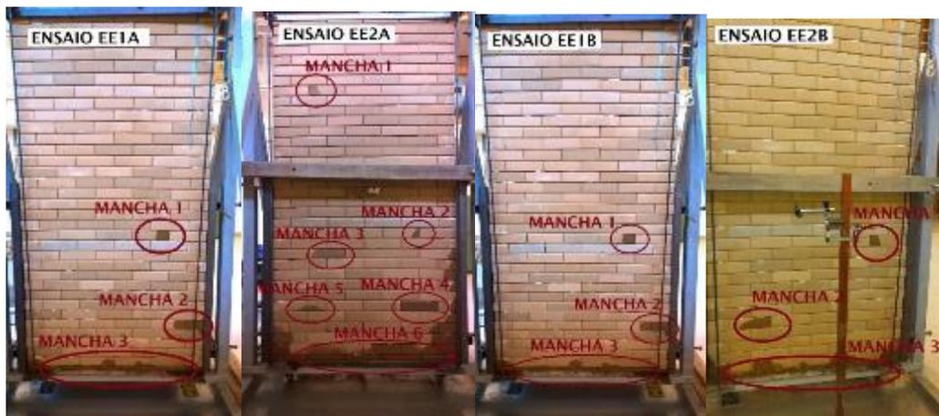
**Figura 5:** Parede A - Análise visual da face interna após o primeiro (EE1A) e segundo (EE2A) ensaio de estanqueidade, respectivamente; Parede B - Análise visual da face interna após o primeiro (EE1B) e segundo (EE2B) ensaio de estanqueidade, respectivamente.
