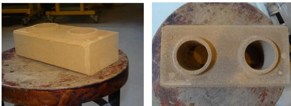
Figura 1: Bloco de solo-cimento submetido à avaliação.
