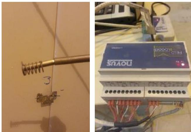
Figura 4: Termopar e Fieldlogger para aquisição de dados.
