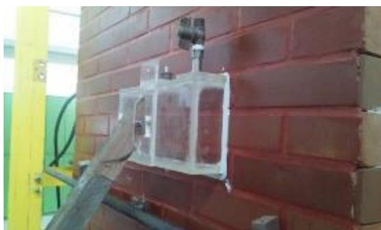
**Figura 3:** Ensaio de permeabilidade à água.
