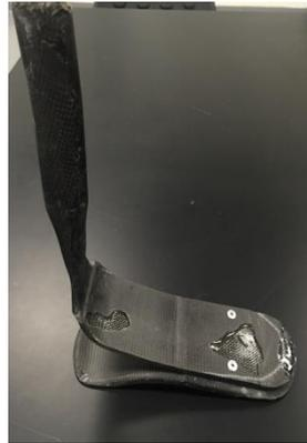
**Figura 13:** Prótesis unida con remaches.
