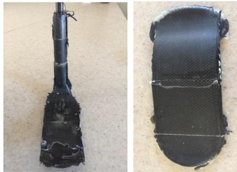
**Figura 10:** Prototipo de fibra de material compuesto.
