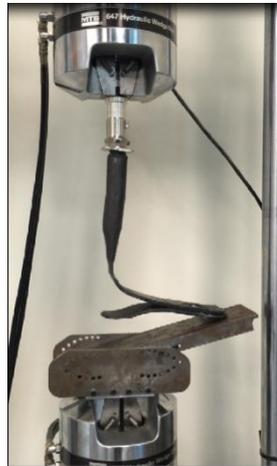
**Figura 15:** Sujeción de prototipo, despegue a 30° de inclinación.
