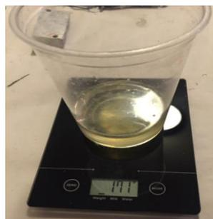
**Figura 7:** Preparación de resina epóxica y catalizador.
