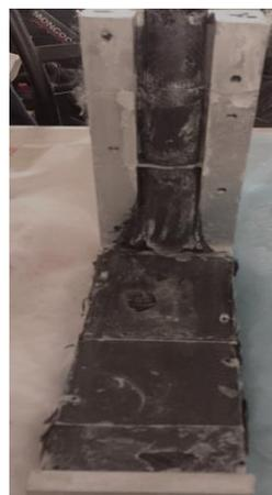
**Figura 14:** Pieza de material compuesto por molde de aluminio.
