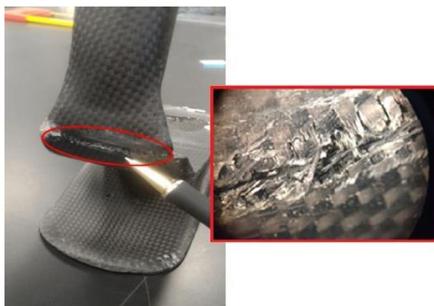
**Figura 17:** Fractura la sección del talón.
