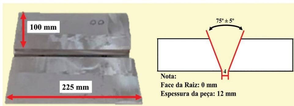
**Figura 1:** Dimensões do corpo de prova e chanfro utilizado na soldagem dissimilar.
