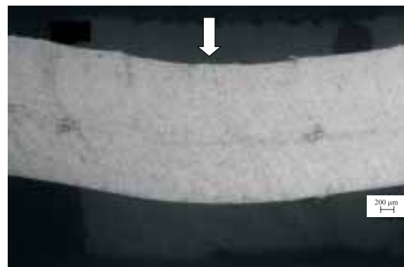
Figura 8. Fotomicrografia eletrônica de varredura de uma amostra de compósito termoplástico ensaiada por cisalhamento interlaminar em 3 pontos (short-beam).
