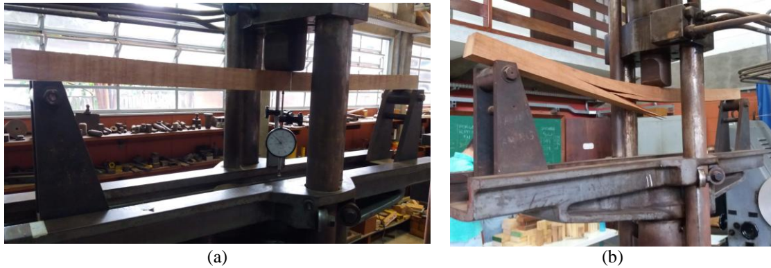
Figura 3 - (a) Ensaio de flexão estática; e (b) corpo de prova após o ensaio
