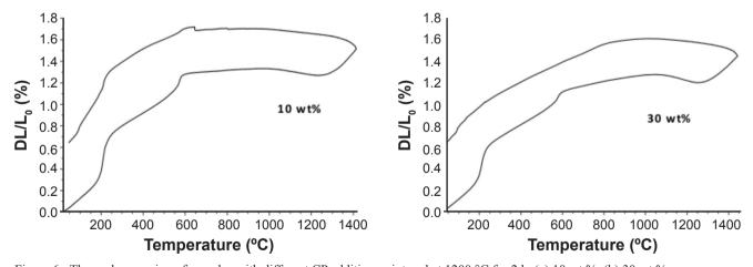
Figure 6: Thermal expansion of samples with different CP additions, sintered at 1200 °C for 2 h, (a) 10 wt.%, (b) 30 wt.%. [Figure 6: Expansão térmica das amostras com diferentes adições de CP, sinterizadas a 1200 °C por 2 h, (a) 10% peso, (b) 30% peso.]
