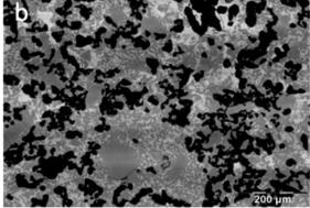
Figure 4: SEM micrographs of samples containing different CP percentages sintered at 1300 °C for 4 h, (a) 10 wt.%, (b) 30 wt.%. [Figura 4: Micrografias obtidas em microscópio eletrônico de varredura das amostras contendo diferentes porcentagens de CP sinterizadas a 1300 °C por 4 h, (a) 10%peso, (b) 30% peso.]
