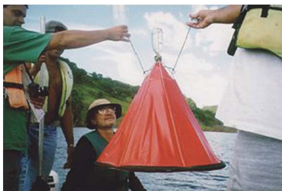
Figura 9 – Medida de emissões de gases do efeito estufa em hidrelétricas pela Coppe-UFRJ e USP/São Carlos.
