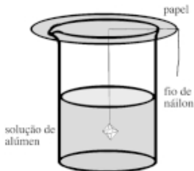
Figura 4. Esquema do sistema utilizado para crescimento de cristal de alumínio
