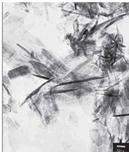
Figura 7. Amostras de hidroxiapatitas sintéticas analisadas em microscopia eletrônica de transmissão mostram cristalitos em forma de agulhas
