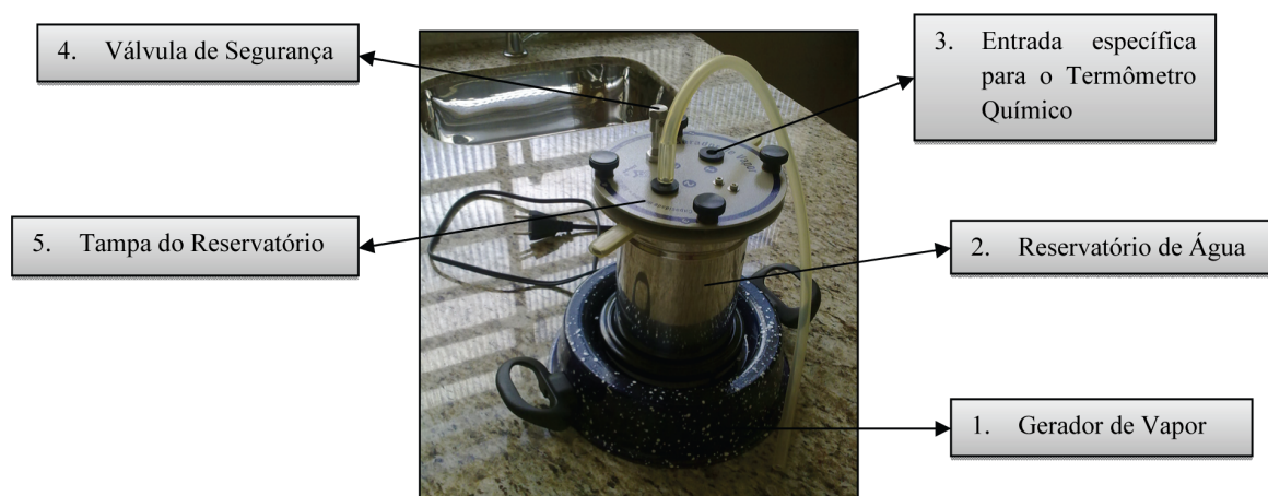
Figura 10 - Gerador de vapor e reservatório de água.
