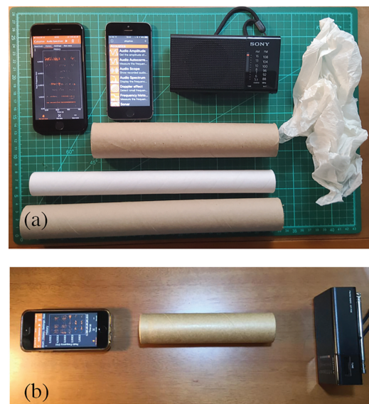
Figura 15: Tubo Aberto: (a) exemplos de materiais utilizados no experimento – os rolos de papelão usados como suporte possuem comprimentos L entre 25 cm – 40 cm e diâmetros D entre 2,5 cm – 4,0 cm; (b) exemplo de montagem experimental usando um rádio fora de sintonia como fonte de ruído e um celular com o aplicativo Phythox para analisar o espectro sonoro que emana do tubo de papelão.
