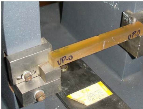
Figura 2: Corpo de prova em posição no pêndulo Charpy.
