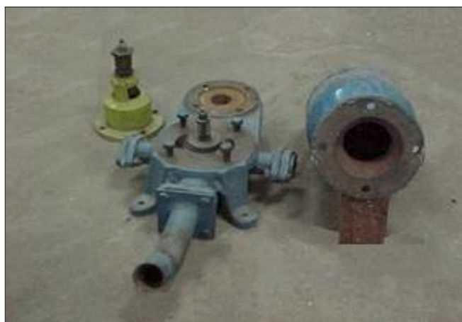
Figura 1 - Vista de um carneiro hidráulico desmontado.
