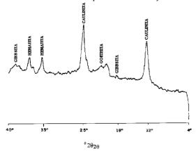
Figura 1. Difractograma de raios-X da fração argila do latossolo.
