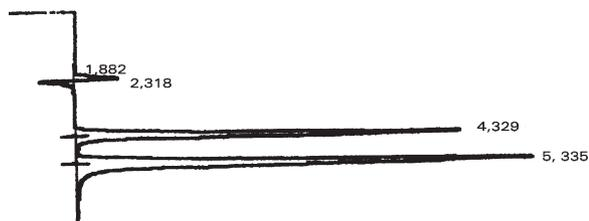
Figura 1. Perfil cromatográfico de  $\beta$ -Lapachona ( $t_r=4,329$ ) e Lapachol ( $t_r=5,335$ )
