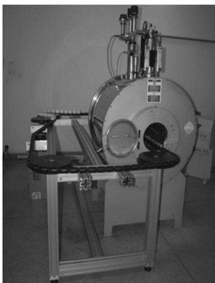
**Figura 3.** Esteira de poliacetal, usada para medidas online, formada por 105 gomos de 65 mm atravessando o bore de 30 cm de diâmetro do magneto de 2,1 T
