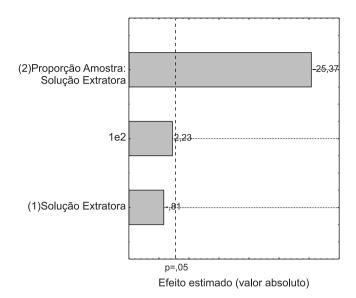
Figura 2. Diagrama de Pareto dos efeitos dos fatores solução extratora e razão amostra: solução extratora sobre a extração do difenoconazol de amostras de morango
