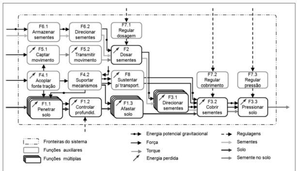
Figura 1 - Estrutura funcional B: representação do fluxo de material, energia e sinal da configuração de uma semeadora puncionadora de empurrar com um dosador e múltiplos puncionadores.
