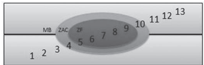
Figura 3. Ilustração da localização onde as medidas foram realizadas (b), no metal de base (MB), zona afetada pelo calor (ZAC) e zona fundida (ZF).
