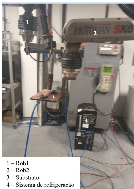
Figura 4. Detalhe do sistema de refrigeração na placa base.
