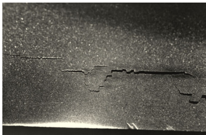
Figura 4. “Stepwise Cracking”. 5,5X de magnificação. Fonte: American Petroleum Institute [78].
