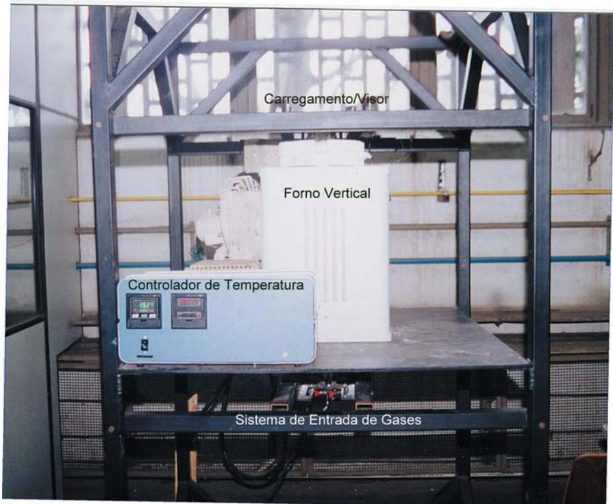
**Figura 1** - Aparato experimental utilizado nos experimentos de fusão dos briquetes de resíduos.
