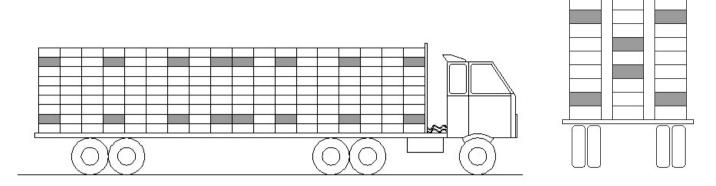
Figura 1 - Distribuição das miniestações meteorológicas (caixas escuras) ao longo da carga.
