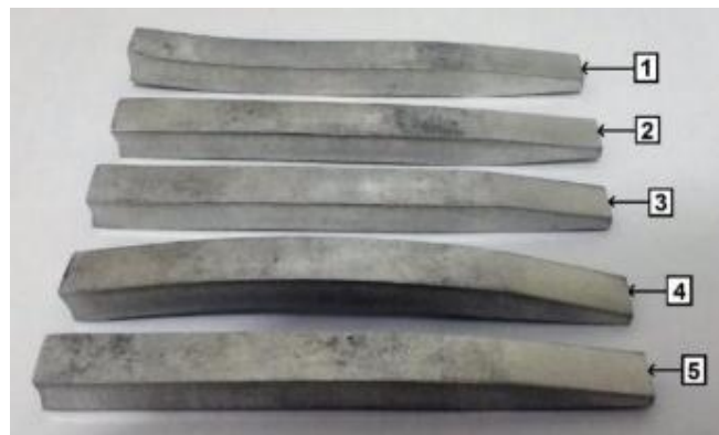
Figura 11: Corpos de alumínio laminados em dois passes.
