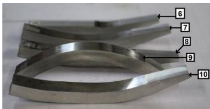
Figura 13: Corpos de alumínio laminados em um passe.
