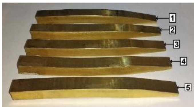
Figura 14: Corpos de latão laminados em dois passes.
