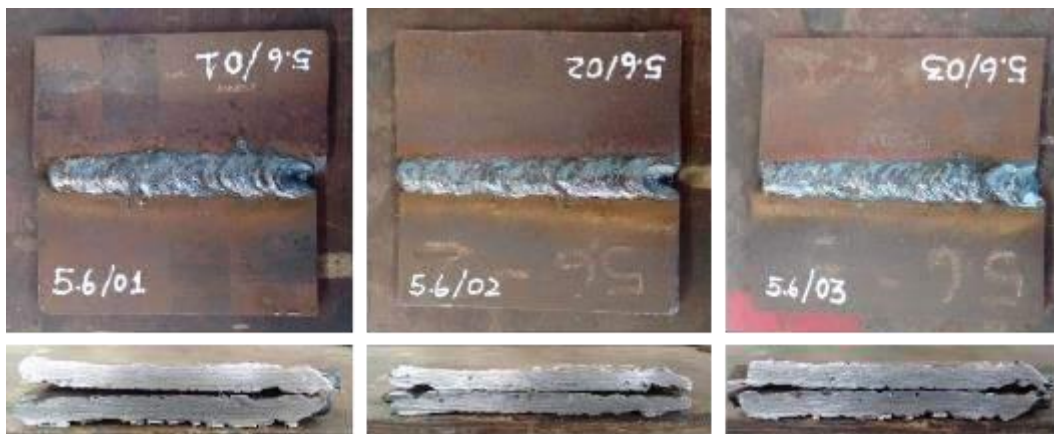
Figura 10: Juntas soldadas com velocidade de correntes de ar de 5,6 m/s. Fonte: O autor.
