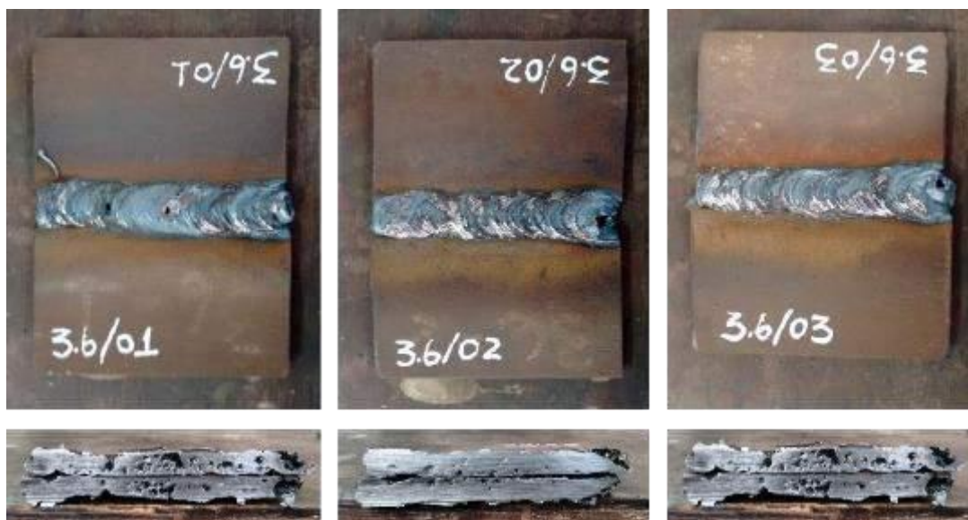
Figura 8: Juntas soldadas com velocidade de correntes de ar de 3,6 m/s. Fonte: O autor
