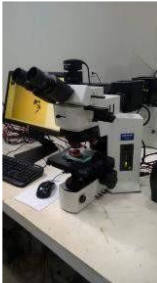
Figura 5: (a) Microscópio Olympus BX51. Fonte: O autor. (b) Microdurômetro Future-Tech FM700. Fonte: O fabricante.
